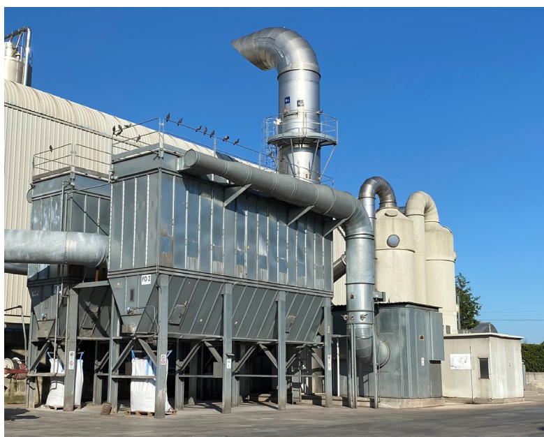
Figura 15-1 – Impianto di abbattimento E11 – Inertizzazione fanghi
