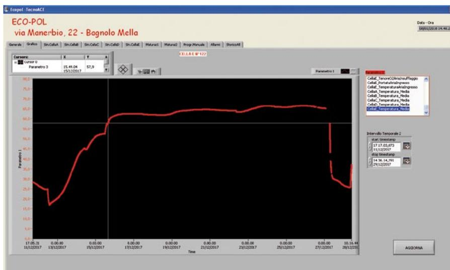
Figura 9-3 - Evoluzione della temperatura durante il compostaggio (maschera del software gestionale monitoraggio cumuli biocelle)
